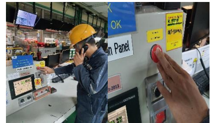
ภาพที่ 3 พนักงานกดปุ่ม Emergency Shut Off Valve ตามคำสั่งของ OC และโทรแจ้งทีม NPC และทีมฉุกเฉิน Linde
