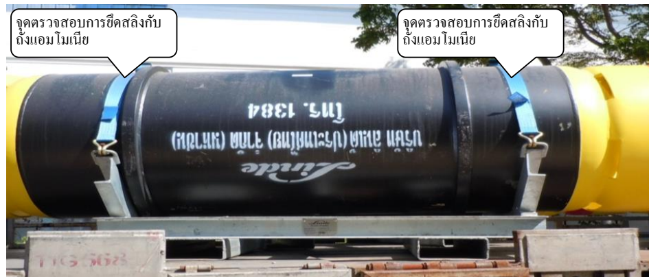
รูปที่ 2 จุดตรวจสอบการใช้สลิงผูกมัด ถังแอมโมเนีย (NH 3 )
