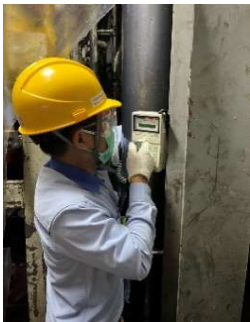
ภาพที่ 7 ทีม PC&SI เข้า ตรวจสอบจุดเกิดเหตุด้วย Survey Meter
