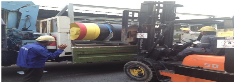
รูปที่ 4 การใช้รถยก (Fork Lift) เสียบขาเข้ากับ Support ของถังแอมโมเนีย (NH 3 )
